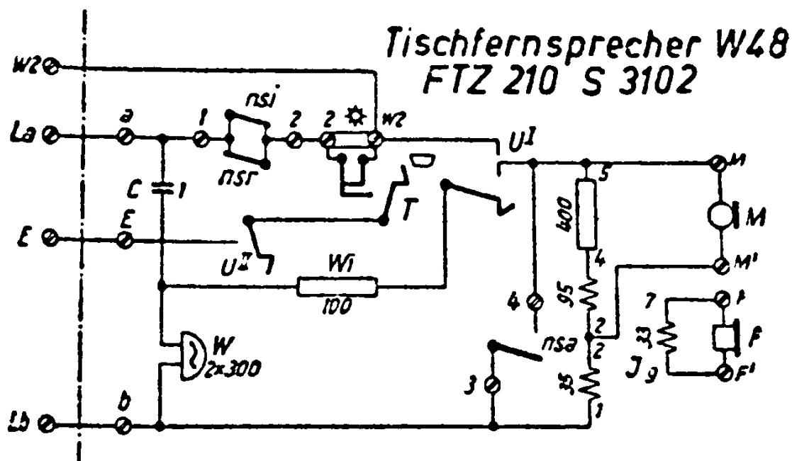
Anschlußschnur normal 3-adrig (3.Ader an E), bei Verwendung eines 2.Weckers gegen 4-adige Schnur auswechseln.
