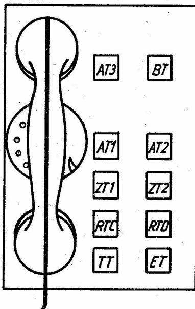
AT1, AT2, AT3, Anschlußleitungstasten mit eingebauten Überwachungslampen (ÜL) grün
