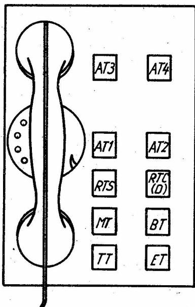
AT1...AT4 Anschlußleitungstasten mit eingebauten Überwachungslampen (ÜL) grün
